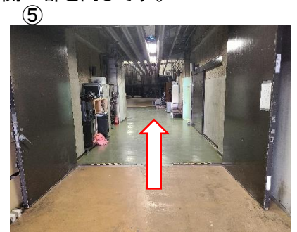
開口部 幅 2m 90cm × 高さ 2m 67cm 地上からは 1m50cmです。 中央奥に光って見えているのが外扉です。 外扉の開口寸法は開口部と同じです。
